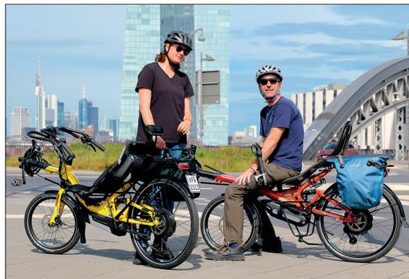
reicht ist. Resultat ist ein Fahr- und Tretgefühl wie auf einem unmotorisierten Rad. Ein weiterer Vorteil dieser Motoren-Bauweise ist ihre Fähigkeit, auf Knopfdruck Energie zu rekuperieren. Bei Bergabfahrten gewinnt das System Ladespannung zurück – und zugleich schont diese Verzögerung durch den Motor die Bremsbeläge.
