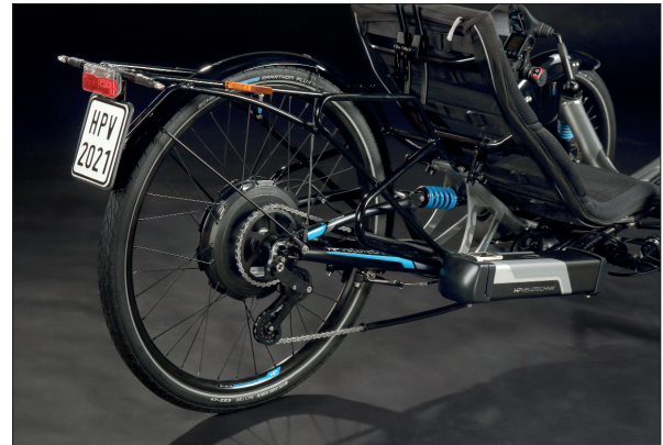
Volle Kraft voraus mit dem Scorpion fs 26 S-Pedelec von HP VELOTECHNIK: Für Highspeed sorgt der Motor Z20 RS von NEODRIVES. Unten: der 651-Wh-Akku.
