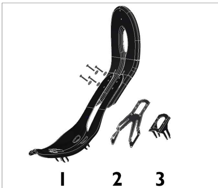
1 - BodyLink Sitz, 2 - Trinkflaschenadapter, 3 - Oberes Sitzblech
