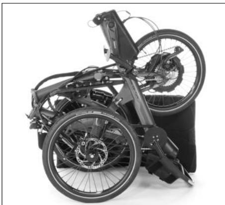
Fig. 2 : Gekko fx 26 plié avec maindaliier Hands-On-Cycle. Le siège a été déposé.
