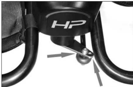
*Fig. 12 : Pour fixer la tringle de commande de direction et pour le réglage de la direction, il y a le choix entre deux perçages sur la biellette.*
