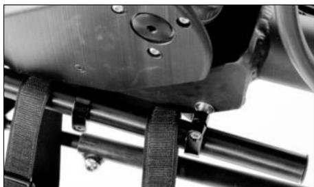
Fig. 8 : Le filet est monté en avant des colliers de fixation
