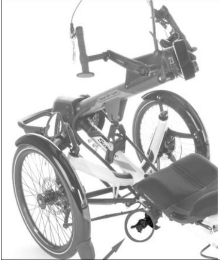
*Fig. 1 : Frein de stationnement : tirez le levier vers l'avant pour verrouiller le frein de stationnement. Rabattez le levier en arrière pour libérer le frein de stationnement.*
