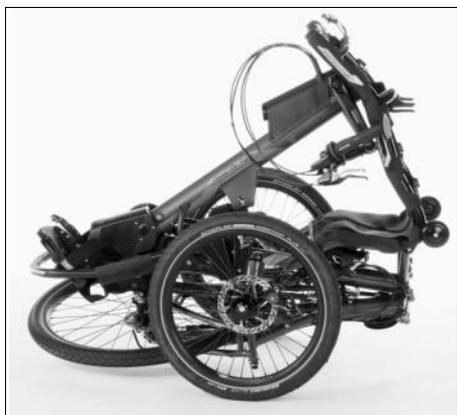
Fig. 1 : Gekko fx 26 plié avec maindaliier Hands-On-Cycle.
