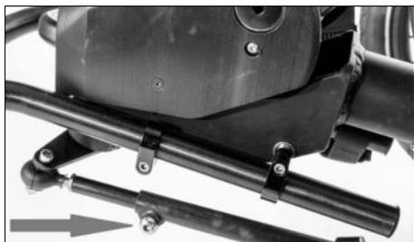
Fig. 3 : Vis de serrage pour réglage longueur tringle de direction
