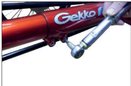
Desserrage des vis de blocage de la bôme.
