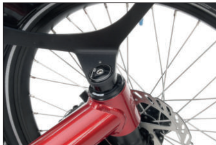
Vue du roulement de tête de direction avec chapeau et vis
