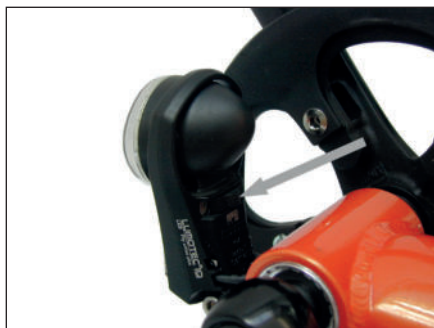
L'éclairage alimenté par une dynamo de moyeu des VAE sont équipés d'un interrupteur sur le feu.
