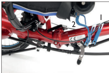
Partie arrière du cadre avec blocages rapides de réglage du cadre (1) et d'assise du siège (2)
