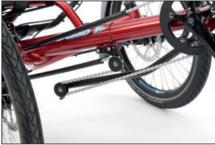
Cadre à réglage rapide avec les deux galets de renvoi de la chaîne.
