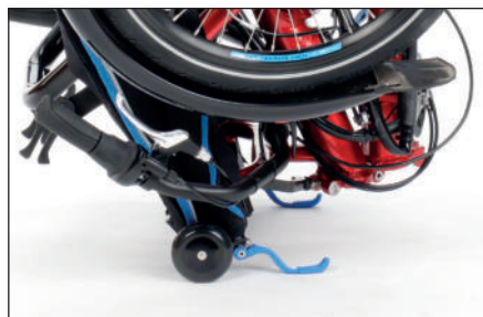
Roulettes de transport et leviers des blocages rapides servant de support au Gekko fxs
