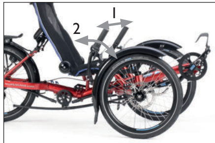
Le guidon se règle en largeur (1) et en inclinaison (2).
