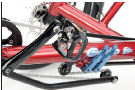
Pédale mixte avec côté automatique sur le Gekko fxs
