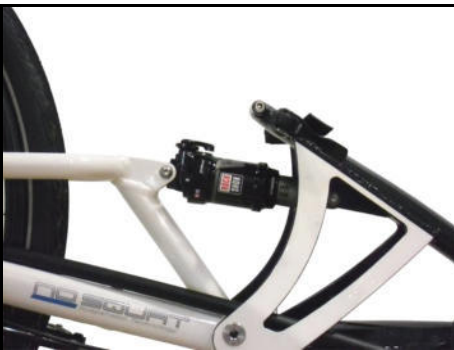
Die Einstellung der Dämpfung erfolgt über das Rad am hinteren Ende. Das Luftfederelement wird so eingebaut, dass der Kipphebel zur Blockierung am hinteren Ende oben liegt.
