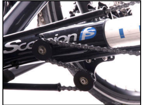
Verlauf der Kette über die Umlenkrollen bei Rahmenschnellverstellung.
