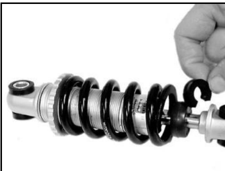
Durch das Aufstecken von Distanzclips auf die Kolbenstange des Federelementes wird der Federweg begrenzt.
