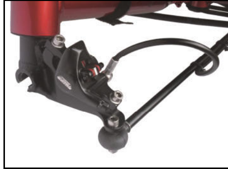
RICHTIG: Korrekte Verlegung der Hydraulikleitung am linken Radträger.
