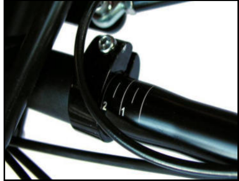
Die Verstellung von Lenkerneigung und -breite erfolgt über die Klemmschellen am Lenkervorbau.
