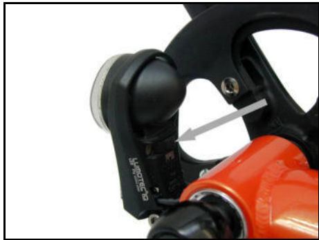
Die Beleuchtung beim Nabendynamo und bei elektrisch unterstützten Rädern wird mit dem Schalter am Scheinwerfer ein- und ausgeschaltet.
