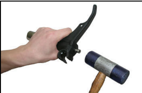
Fetten der Führungsbuchse
