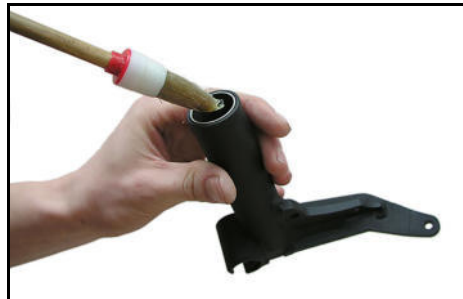
Fetten der Führungsbuchse
