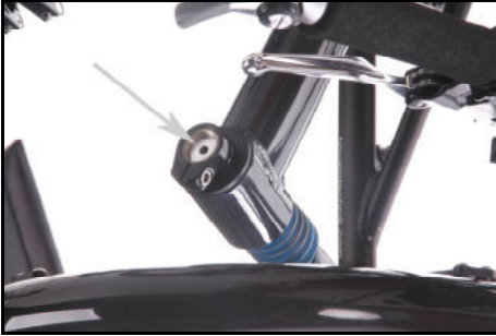
Einstellschraube für die Federvorspannung des Federelements im Inneren des Radträgers
