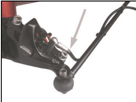
FALSCH: Der Bogen der Hydraulikleitung läuft vor der Spurstange: Gefahr des Abknickens (Pfeil).
