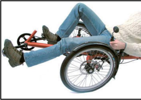
Der Tretlagerausleger wird so eingestellt, dass das Knie beim Fahren gerade nicht maximal durchgestreckt wird.
