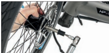
Praktisch beim Transport: HP VELOTECHNIK hat offene Radträger entwickelt, mit denen die Vorderräder mitsamt den Bremscheiben nach dem Lösen nur einer Schraube einfach abgenommen werden können. (HP Performance Naben sind Serienausstattung am Scorpion)
