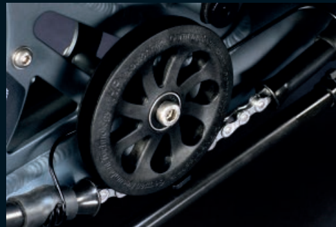
Große, effiziente Kettenleitrolle. Auf dem integrierten Mittelsteg liegt die Kette wie bei einem Kettenblatt leise auf. Auswechselbare Rillenkugellager.
