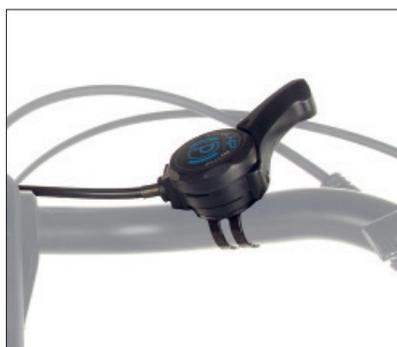
Was im Auto die Handbremse leistet, besorgt am Dreirad die *Parkbremse*: sicheres Abstellen auch an abschüssigen Orten. Sie ist ganz einfach mit dem großen Daumenrasthebel zu bedienen und bietet sich für die Montage am Hinterrad an. Wünschen Sie die *Parkbremse* am Vorderrad, schränkt das die Teilbarkeit Ihres *Delta tx* ein.
