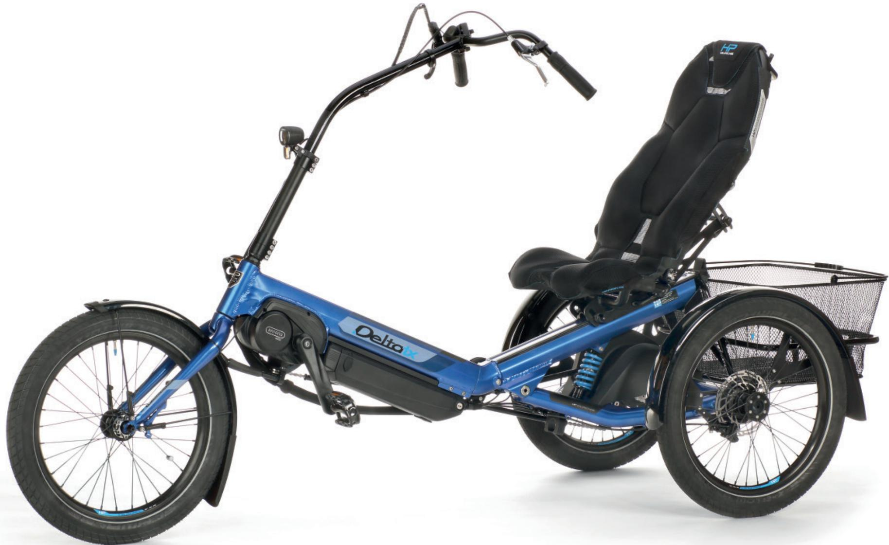
**Greifen Sie zu!** So locker und entspannt wie Sie sitzen, haben Sie auch den Lenker im Griff. Dabei sorgt die ausgeklügelte Konstruktion für ruhigen Geradeauslauf und höchste Flexibilität. Der Wendekreis beträgt lediglich 3,20 Meter!
