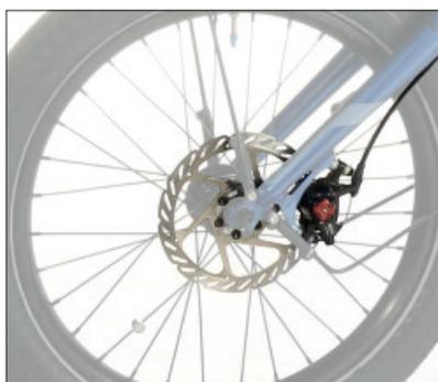
Ihr Rad wird mit zwei unabhängigen Bremsen ausgestattet. Serienmäßig haben Sie am *Delta tx* dafür getrennt angesteuerte Hinterradbremmen. Wählen Sie die Option *Gekoppelte Scheibenbremse*, benötigen Sie einen Zusatzstopper: Wird der auf Ihren Wunsch statt am Hinterrad am Vorderrad montiert, schränkt das die Teilbarkeit des Rades ein aufgrund der Zugverlegung.
