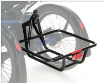
Der **Gepäckträger** aus kräftigem 20 mm Alurohr trägt 25 kg. Das Gestell kann auch ohne Korb zum Transport z.B. einer Getränkekiste dienen. Wenn Sie beim Rad teilen auch den Korb abnehmen wollen: die 3 Schrauben des Trägers lösen und Rücklichtstecker trennen.
