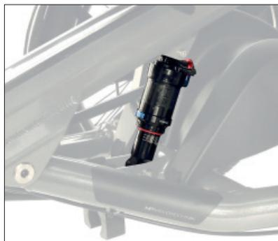
Luftfederelement *Monarch RL* von ROCK SHOX. Praktisch: Dank der mitgelieferten Pumpe können Sie die Federhärte an die Zuladung anpassen. Mit einstellbarer hydraulischer Zugstufendämpfung und blockierbarer Druckstufe ausgestattet, überzeugt es mit hervorragendem Ansprechverhalten und einer klaren Gewichtsersparnis gegenüber dem Stahlfederelement DNM DV-22.
