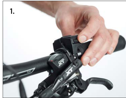
1. Einschalten des Akkus über die Ein-/Aus-Taste des Systems. Der Bildschirm benötigt wenige Sekunden und zeigt dann den Startbildschirm an.
