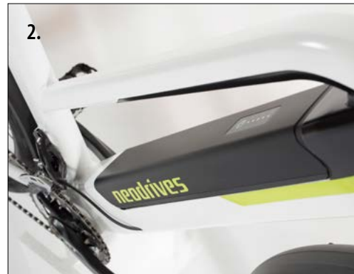
2. Semiintegrierter Akku mit Akkutaste: Akkutaste betätigen nicht nötig
