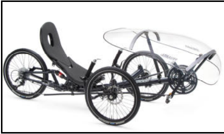
Un carénage Streamer contre la pluie monté sur un Scorpion
