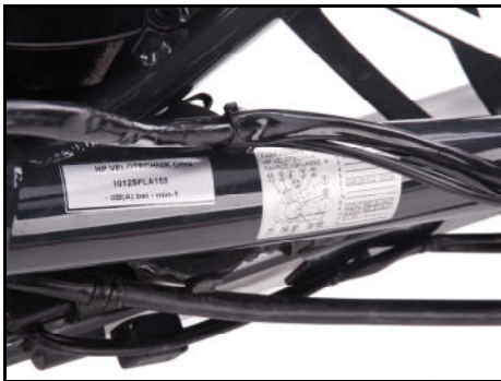
Plaque constructeur (à gauche) et plaque d'authentification du S-Pedelec
