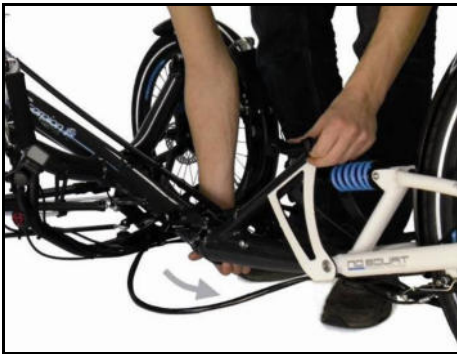
Déblocage de la languelette de sécurité de l'articulation
