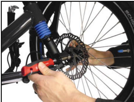
Dépose de la roue avant : dévisser de la vis de la douille d'extrémité d'axe
