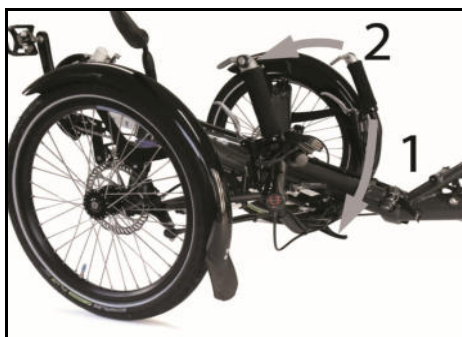
Le guidon des modèles Scorpion se règle en largeur (1) et en (2) inclinaison.
