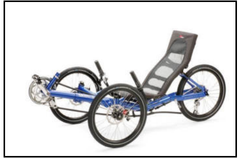
Le siège des modèles Gekko reste fixé au vélo lorsqu'on le plie ou qu'on le démonte.
