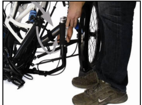
Une sangle à Velcro retient la traverse pour maintenir le vélo plié
