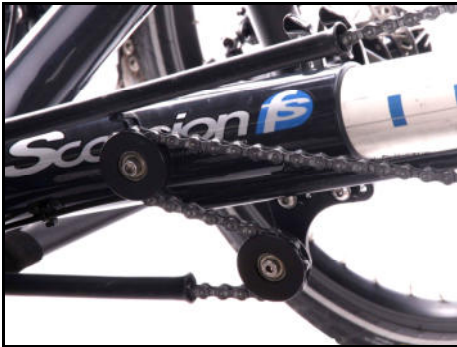
Cadre à réglage rapide avec les deux galets de renvoi de la chaîne
