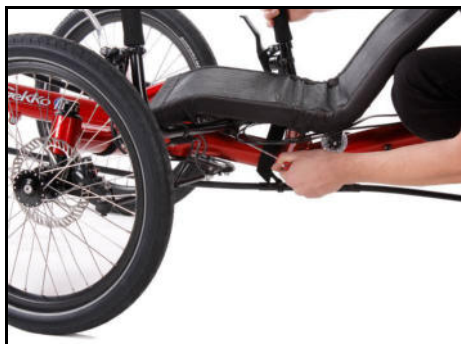
Les réglages du guidon se font avec les brides situées sur la barre de direction sous le siège
