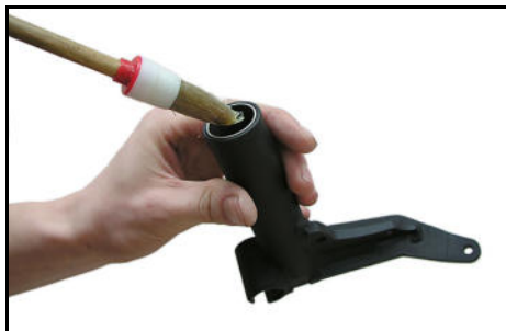
Graissage des douilles de guidage
