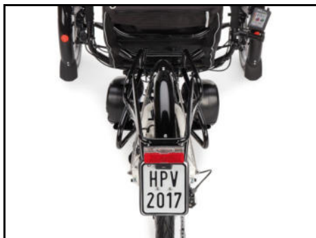
Ensemble de feux arrière, avec feu stop, sur le porte-bagages du S-Pedelec
