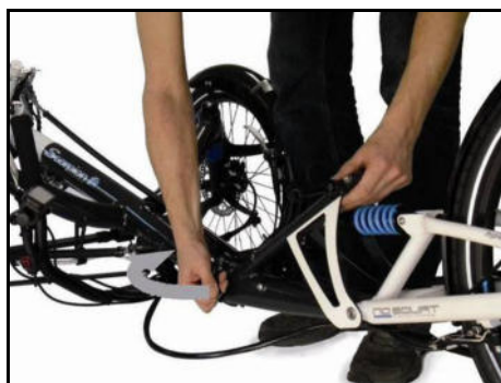
Ouverture du blocage rapide de l'articulation
