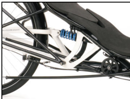
Poulie de renvoi, guide-chaîne et gaines de chaîne du Scorpion fs 26
