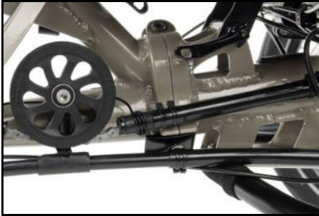
Languelette de sécurité du cadre pliant du Scorpion plus 26
