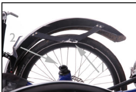
Montage des garde-boue des Scorpion, Scorpion fx, Gekko fx 20 et Gekko fx 26
