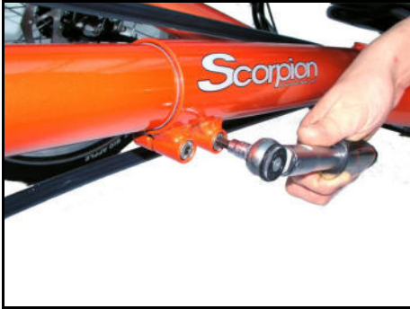
Desserrage des vis de blocage de la bôme
