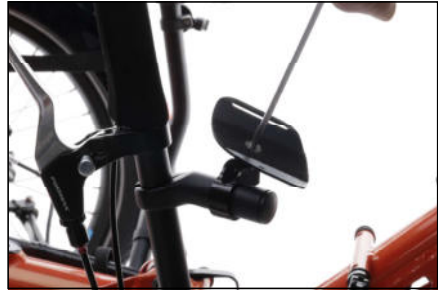
Ausrichten des Tellers der Handauflage
