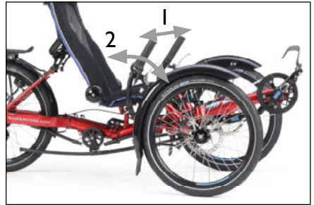
Der Lenker lässt sich in Breite (1) und Neigung (2) verstellen
