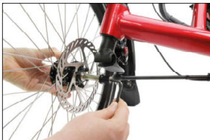
Vorderradausbau: Lösen der Schraube im Endstück und dann Achse aus dem Radträger lösen.
