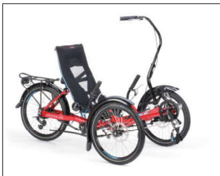
Der stabile Begleitergriff am Gekko fxs ermöglicht Mitlenken, Beschleunigen und auch aktives Bremsen
