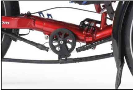
Kettenleitrolle und Kettenschutzrohre am Gekko fx
