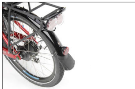
Hintere Lichtanlage am Gepäckträger
