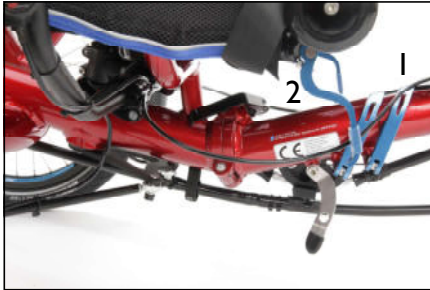
Hinteres Rahmenteil mit Rahmenschnellspanner (1) und Sitzflächenschnellspanner (2)
