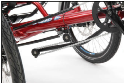
Verlauf der Kette über die Umlenkrollen bei Rahmenschnellverstellung
