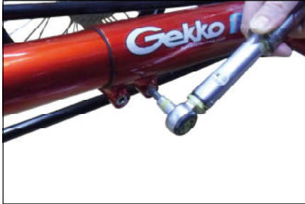
Lösen der Klemmschrauben zum Verstellen des Tretlagerauslegers.
