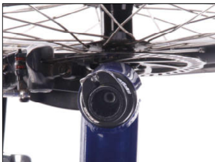
Geöffnetes Steuerkopflager mit Einschraubkralle im Inneren
