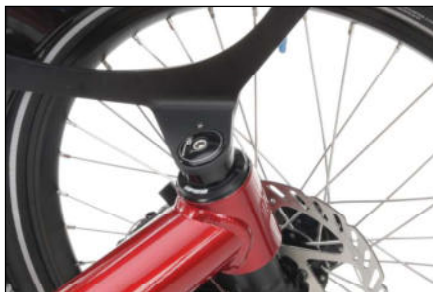
Ansicht des Steuerkopflagers mit Abdeckschraube und montiertem Schutzblech
