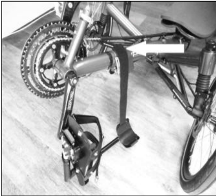
Positionierung des Klettstreifens als Halterung für die Unterschenkelfixierung
