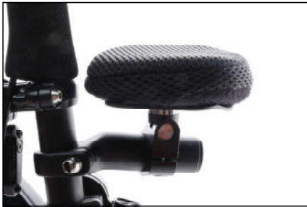
Position der rechten Handauflage am Lenker
