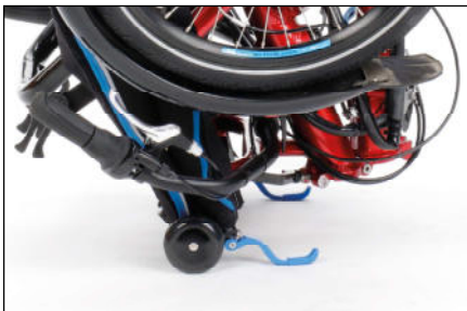
Transportrollen und Sitzschnellspanner mit Stand- funktion am Gekko fxs
