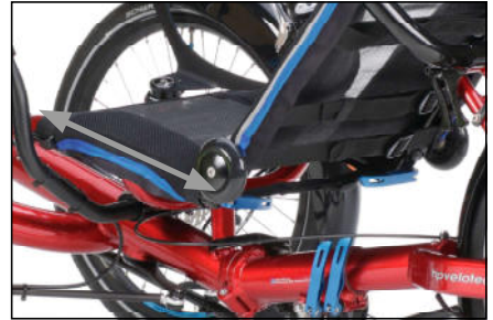
Die Sitzfläche lässt sich in der Länge einschieben oder herausziehen.
