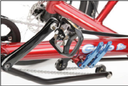
Kombipedal mit Klickpedalseite am Gekko fxs
