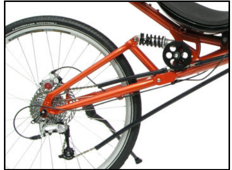
Poulie guide-chaîne et gaines de protection de la chaîne sur une Streetmachine Gte.
