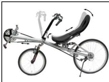
Possibilités de réglage des sièges BODYLINK® (Streetmachine Gte, version avec guidon rabattable)
