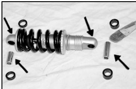
Les coussinets du combiné sont à graisser.
