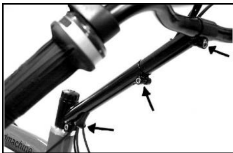
Liaisons vissées de la potence de guidon haut fixe
