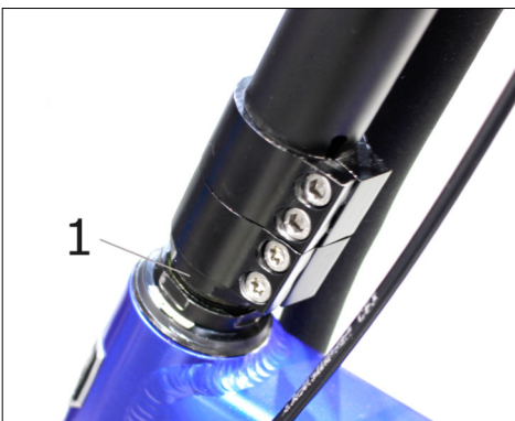
1 - Einstellvorrichtung zum Einstellen des Steuerlagerspiels
