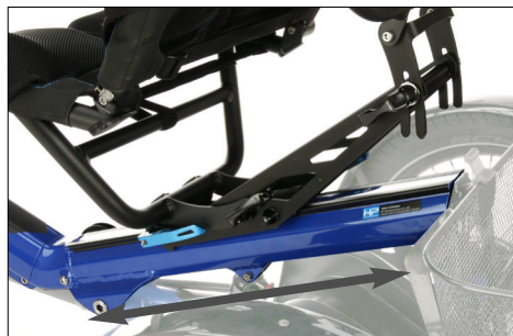
Der Sitzadapter kann auf dem hinteren Teil des Hauptrahmens verschoben werden, um die Sitzposition auf die Beinlänge anzupassen.
