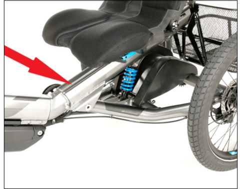
Die Rahmennummer befindet sich auf der linken Rahmenseite vorn am seitlichen Rand der Sitzschiene.
