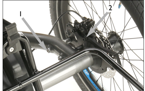
1 - Befestigung des Bremsanbaublechs 2 - Bremssattelbefestigung
