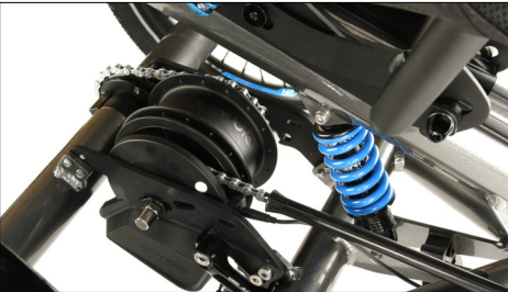
Zwischengetriebe mit ENVIOLO-Nabe
