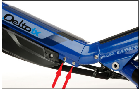
Klemmschrauben der Rahmenklemmung
