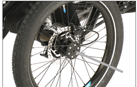
Zentrale Befestigungsschraube der Hinterradnabe
