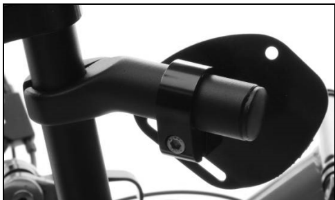
Klemmschelle mit Befestigungsschraube M5x16
