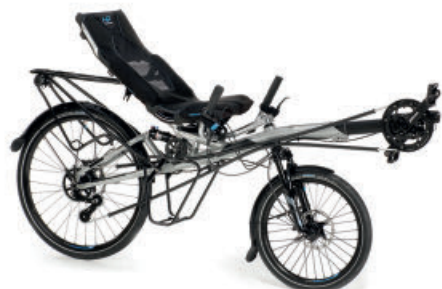
Streetmachine Gte: Komfortables voll gefedertes Reiserad mit 26- Zoll-Hinterrad mit Platz für 4 große Gepäcktaschen ab € 3.490
