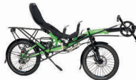
Grasshopper fx: Schnell faltbares, voll gedefertes Trekking- Liegerad mit kompaktem 20-Zoll-Hinterrad und mittlerer Sitzhöhe, ideal auch für kleinere Fahrer, ab € 3.990
