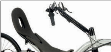
Alternativen fürs Cockpit: Der Deichsellenker kombiniert eine entspannte Armhaltung mit einer guten Aerodynamik. Die Hände liegen locker vor der Brust.
