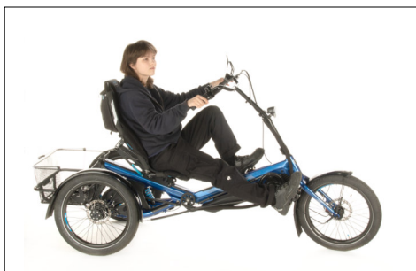
Partie centrale de la potence courte, raccourcie de 2 cm, Taille de la conductrice 1,61 m
