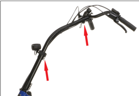
Profondeurs d'insertion minimales des éléments de potence : La fente de serrage (en haut) et le perçage (en bas) doivent être complètement remplis par l'élément de potence situé à l'intérieur.
