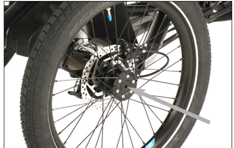
Vis de fixation centrale du moyeu de la roue arrière
