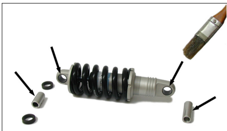
Les coussinets de l'élément à ressort doivent être lubrifiés avec de la graisse.
