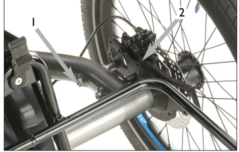
1 - Fixation de la plaquette de frein 2 - Fixation de l'étrier de frein
