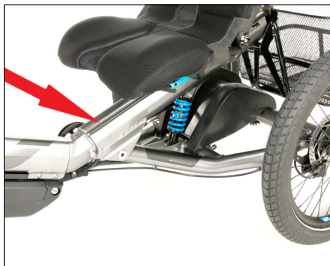
Le numéro de cadre se trouve sur le côté gauche du cadre, à l'avant, sur le bord latéral du rail du siège.
